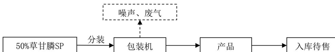
图3-6 50%草甘膦SP生产工艺流程及产污环节图
